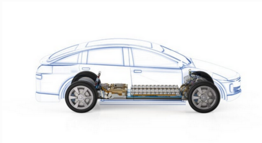
Die Batterien eines E-Autos befinden sich in der Regel am Unterboden des Fahrzeugs. Foto: iStock
